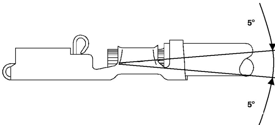
Die Abweichung der Längsachse darf im Crimpbereich nicht größer als 5° nach oben oder unten betragen.
