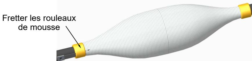
6-2.4: - Sur l'ensemble du montage, en débordant de 10mm sur chaque joint d'étanchéité, rubaner 2 couches de ruban d'étanchéité transparent à 1/2 recouvrement, en positionnant la valve d'injection au centre de la jonction, puis 2 valves d'évent aux extrémités au ras des joints d'étanchéité (voir schéma ci-dessous) et 2 valves d'évent aux 2 points les plus hauts de l'accessoire.
