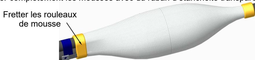
3-2.4: - Sur l'ensemble du montage, en débordant de 10mm sur chaque joint d'étanchéité, rubaner 2 couches de ruban d'étanchéité transparent à 1/2 recouvrement, en positionnant la valve d'injection au centre de la jonction, puis 2 valves d'évent aux extrémités au ras des joints d'étanchéité (voir schéma ci-dessous) et 2 valves d'évent aux 2 points les plus hauts de l'accessoire.
