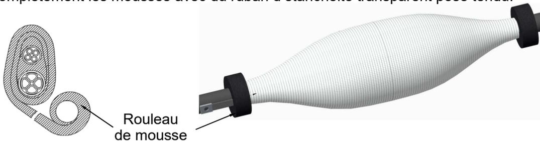
6-2.3: - Fretter complètement les mousses avec du ruban d'étanchéité transparent posé tendu.
