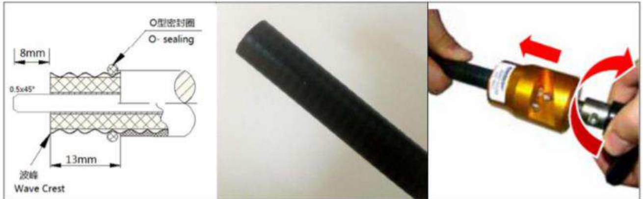
1. 标准剥线长度 1. Standard stripping dimension
