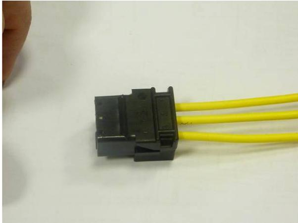
Il rabat le verrou secondaire vers l'arrière du boîtier derrière les deux ergots de verrouillage. Deux «clics» l'informent du bon verrouillage.
