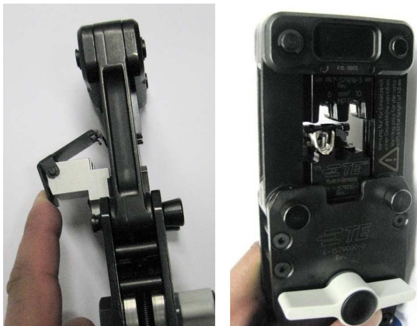
Abb. 3 : Kontaktaufnahme geöffnet (links), Kontakt positioniert (rechts)
