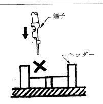
スプリングヘッダーを基板へ装着する際は,スプリングヘッ ダーの中央部を指で押し付けて,スプリングヘッダー底面が 基板面に密着する様に取り付けて下さい。
