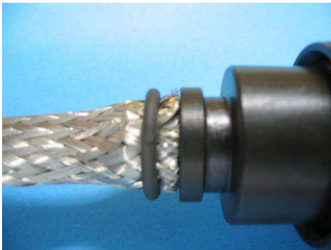
ACCEPTABLE Terminaison standard
