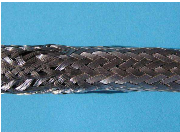
INACCEPTABLE Couverture inégale
