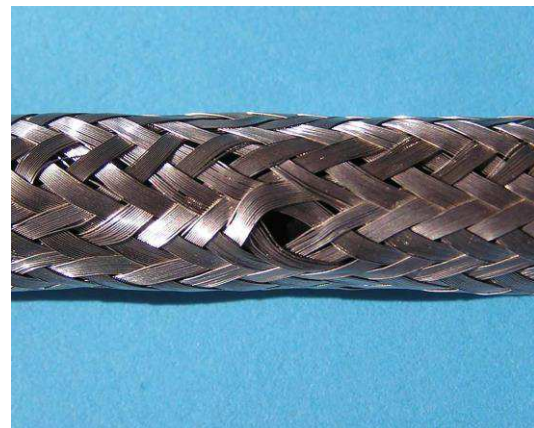
INACCEPTABLE Fenêtre dans le blindage
