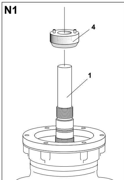
Смазать поддерживающую шайбу силиконовой смазкой (4). Накрутить поддерживающую шайбу на наконечник (1).
