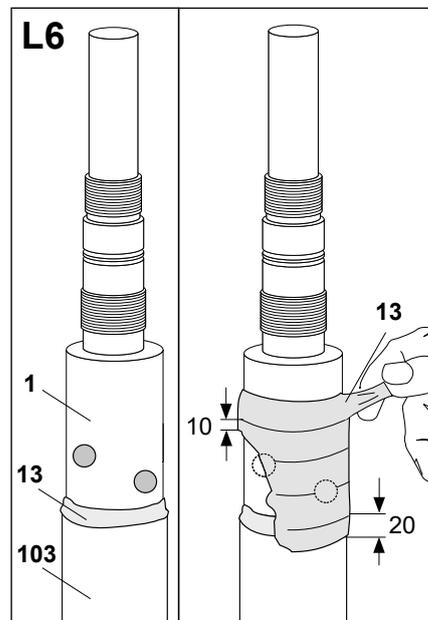
Если имеется зазор между наконечником (1) и срезом изоляции (103), заполнить его с помощью желтой ленты (13), тщательно растягивая ее в процессе заполнения. Намотать желтую мастику на кабельный наконечник, как показано на рисунке с заходом на изоляцию кабеля (103) на 20 мм и на 10 мм выше верхнего срывного болта.
