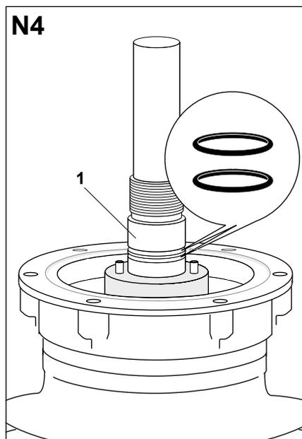
Смазать большое O-образное уплотнительное кольцо силиконовой смазкой и установить его в паз верхнего фланца композитного изолятора.
