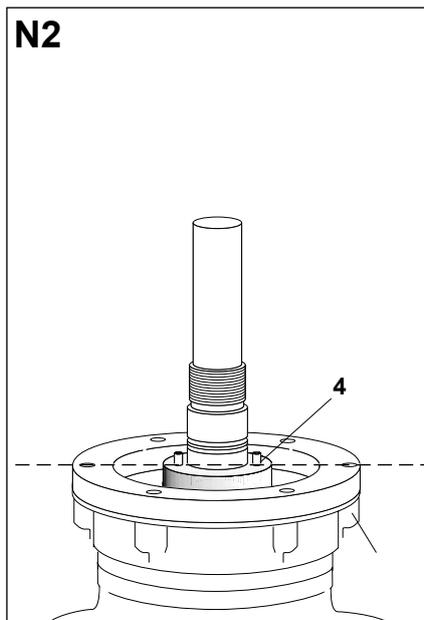
Закрутить поддерживающую шайбу (4) временно таким образом, чтобы плоскость поддерживающей шайбы **совпадала** с верхней плоскостью металлического фланца композитного изолятора (5), как показано на рисунке.
