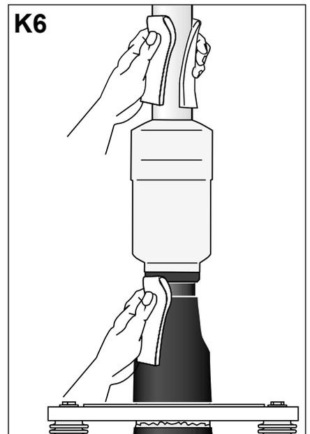
Очистить от смазки кабель и все установленные компоненты.
