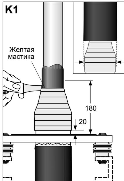
Вымотать один слой жёлтой мастики с 50% перекрытием поверх кабеля, растягивая ленту на 50% ширины в процессе намотки. Продолжить выматывание мастики, начав в 20 мм от плиты основания, и закончить намотку в 180 мм выше плиты основания, как показано на рисунке.
