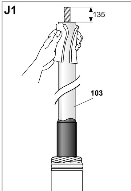
Удалить изоляцию (**103**), на участке длиной 135 мм, с токопроводящей жилы кабеля.
