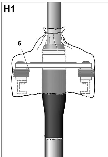
Закрывать плиту основания (6) от попадания грязи и пыли с помощью стретч-пленки.
