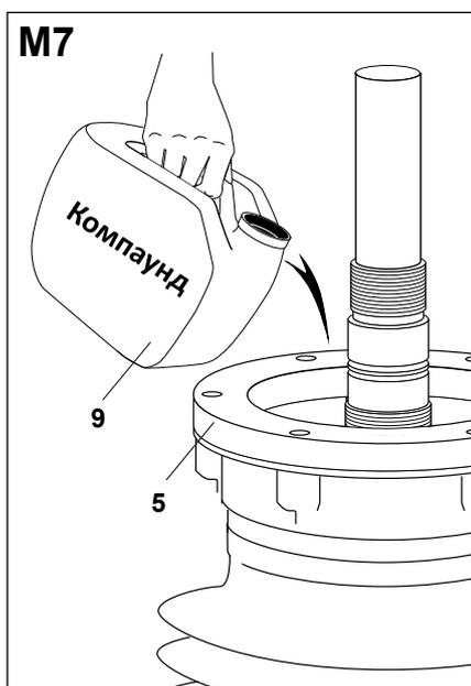
Следить за уровнем заливки. Убедиться, что верхний уровень компаунда находится в 300 мм от верхней части композитного изолятора (5).
