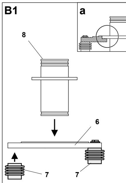
Временно зафиксировать опорные изоляторы (7) к плите основания (6) с помощью болтов большей длины.
