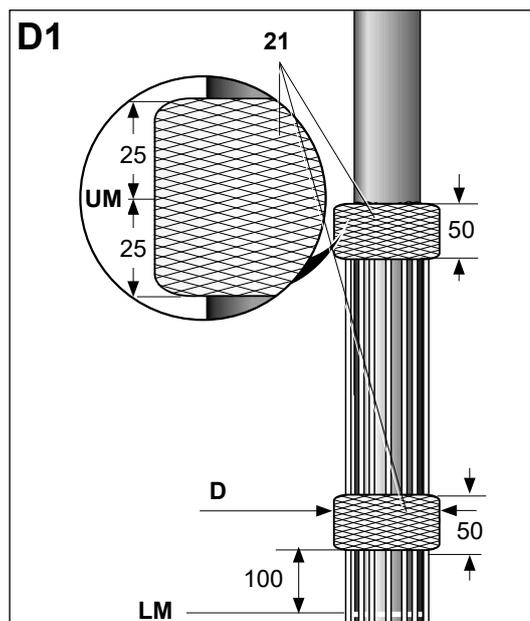
Намотать утолщение текстильной лентой шириной 50 мм (**21**) на верхней отметке, как показано на рисунке D1.
