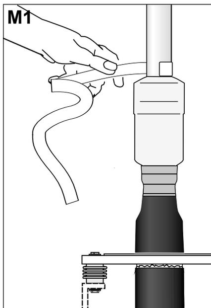
Удалить прозрачную ленту с изоляции кабеля, намотанную над выравнивающим конусом.
