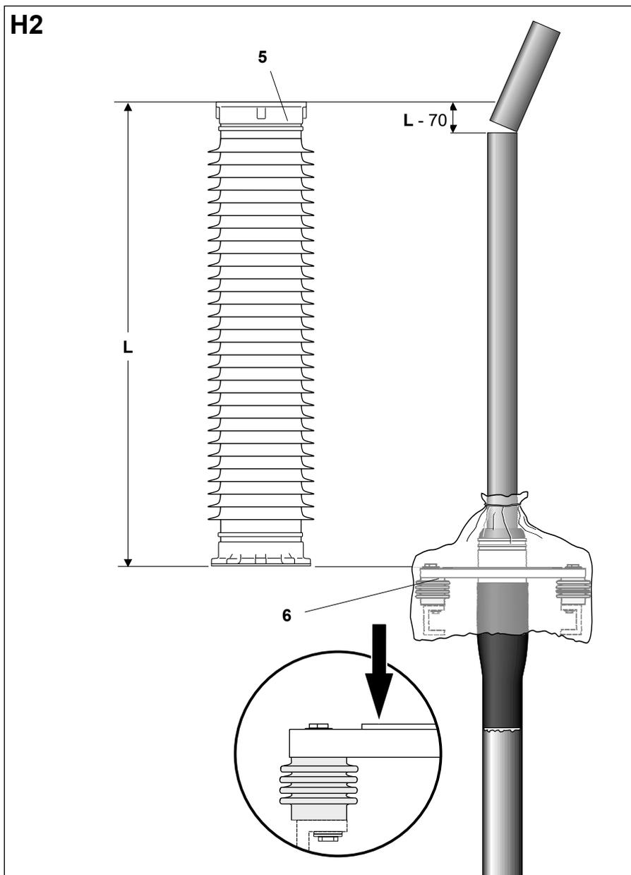
Измерить высоту **L** **внутри** поставляемого композитного изолятора (5).
