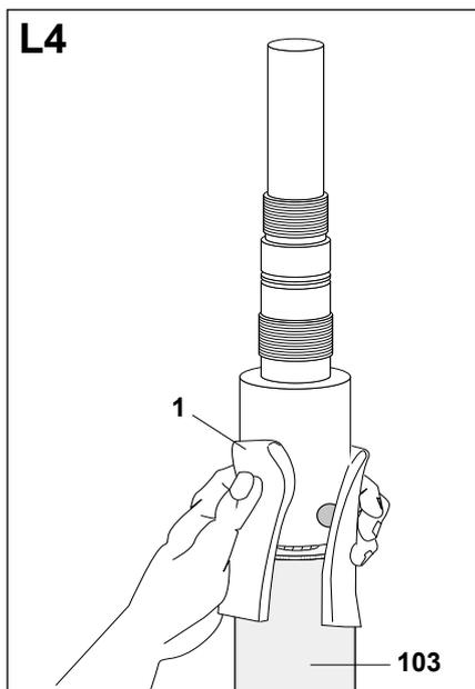
Обезжирить и очистить наконечник (1) и изоляцию кабеля (103). Снять поддерживающую шайбу.
