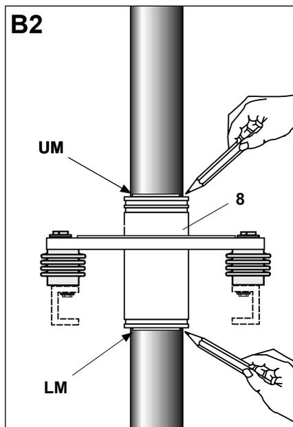
Сделать отметку на кабеле сверху стакана кабельного уплотнения (8) (UM) и на кабеле снизу стакана кабельного уплотнения (8) (LM). Для нанесения отметки использовать маркер либо ленту ПВХ, как показано на рисунке.
