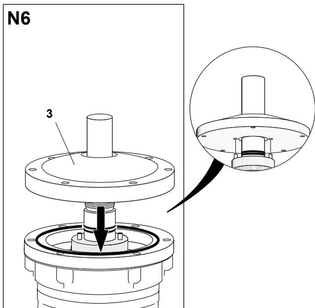
Надеть крышку (3) композитного изолятора на наконечник.
