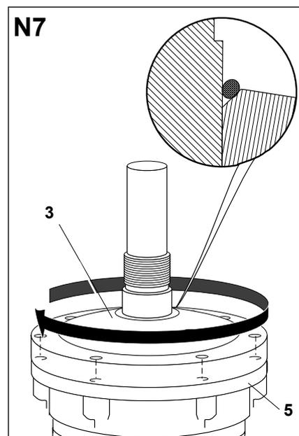
Закрутить крышку (3) композитного изолятора до тех пор, пока крышка не коснется фланца композитного изолятора (5). Затем повернуть крышку еще на один оборот. Убедиться, что отверстия на крышке совпали с отверстиями на фланце композитного изолятора. Смазать O-образное кольцо. Надеть O-образное кольцо на наконечник и установить его в паз между наконечником и крышкой композитного изолятора.
