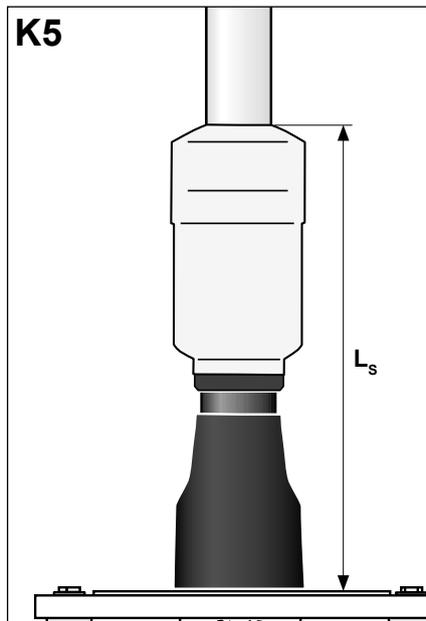
Вращательными движениями натягивать выравнивающий конус на кабель до тех пор, пока его нижняя часть не достигнет отметки на внешнем п/п слое.
