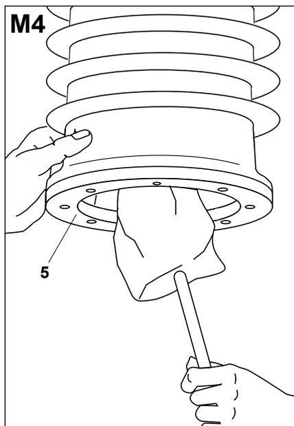
Тщательно вымыть и очистить внутри композитный изолятор (5), а также его верхний и нижний фланец.
