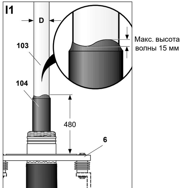
Тщательно удалить внешний п/п слой (**104**) по всей длине разделки, не доходя 480 мм до плиты основания (**6**).
