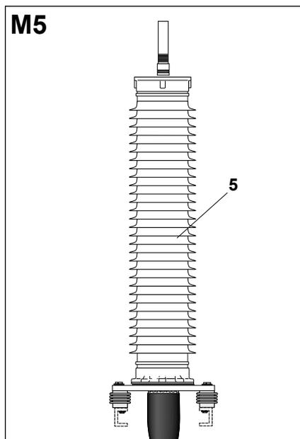
Аккуратно надвинуть на кабель композитный изолятор (5), установив его большим фланцем вниз на плиту основания муфты.
