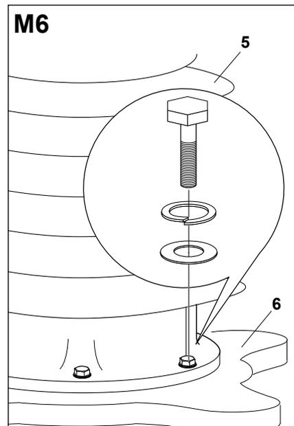
Смазать болты специальной смазкой из комплекта. Зафиксировать композитный корпус (5) на плите основания (6), как показано на рисунке. Затянуть болты крест-накрест с усилием 55 Нм, используя динамометрический ключ.
