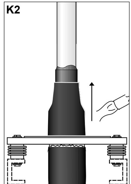
Установить короткую **бесклеевую** термоусаживаемую трубку (длиной **200 мм**) на кабель, вплотную к плите основания муфты и усадить её. Усадку начать от плиты основания и двигаться вверх.
