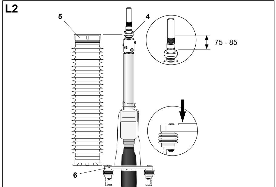
Проверить расстояние между плитой основания (6) и верхней точкой поддерживающей шайбы (4). Установить поддерживающую шайбу таким образом, чтобы плоскость поддерживающей шайбы и плоскость верхнего фланца изолятора (5) были на одном уровне. Если это невозможно сделать, необходимо переразделать кабель.
