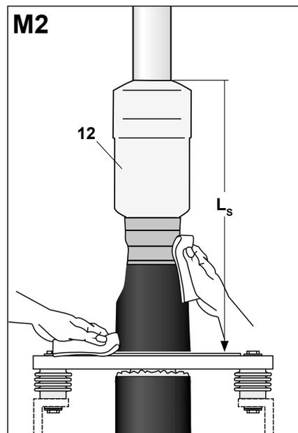
Очистить и обезжирить плиту основания, кабельное уплотнение и другие установленные компоненты. Проверить размер  $L_s$  и сравнить с ранее полученным значением. Разница не должна превышать  $\pm 10$ мм.
