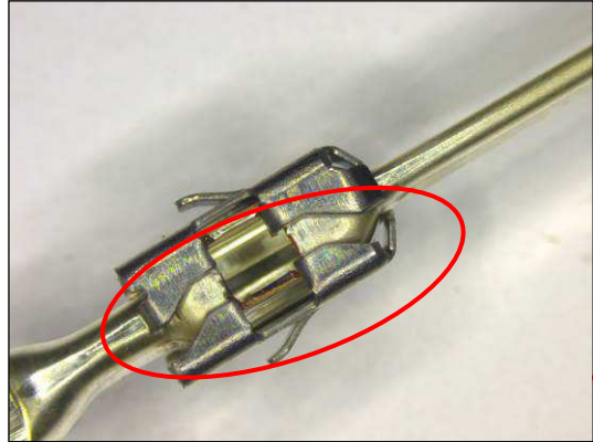
Bild schlecht / worse case deformation / dimension stability
