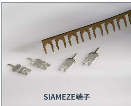
TE ConnectivityのSIAMEZE端子は、MAG-MATE端子と同様に、圧接技術を採用しており、マグネットワイヤを被覆除去することなく、確実なメタル間インターフェースを実現しています。SIAMEZE端子は、よりスペースに制約のあるモータシステムを意図したコンパクトな設計であり、高い保持力でリード線を固定するためのオプションのLead Lokを特徴とします。このシステムは、自動または手動アセンブリに適用可能であり、事前の被覆除去を必要とせず、銅またはアルミニウムのマグネットワイヤの安定した気密接続を達成しています。
