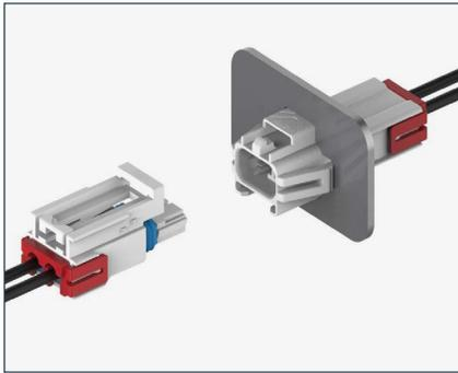
パワーサーロックコネクタは、水やほこりに対するIP67定格の保護を備えた高性能の電線対電線の電源接続を提供します。取り付けクリップがフリーハンギングコネクタを固定し、ツイストアンドロック(TNL)キャップにより、接続部に結露がとどまることはありません。ハウジングは、UL 94 V-0およびグローワイヤテスト(GWT)難燃性規格を満たしています。最高温度は125°Cです。また、固定タブおよびレセプタクル接点システムおよびオプションのダブルロックプレート(TPA)もあります。アプリケーションとしては、コントロールボード、ヒューマンマシンインターフェース、電源ボード、ファン/ステップモータなどがあります。
