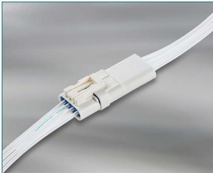
2.5mmシールドシグナルダブルロックコネクタは、低電源および信号用途においてコンパクトで耐久性のある接続を作成するための設計の柔軟性を提供します。この製品シリーズには、製造と最終使用での不具合からの製品の保護に役立つ多くのオプション機能が用意されています。このような機能として、アセンブリ段階に確実な嵌合を実現するダブルロックプレート、コンフォーマルコーティングを施した基板上で使用するためのハイプロファイルヘッダ、および高温環境と湿潤環境に優れた性能を発揮するIP67定格シールドコネクタが用意されています。
