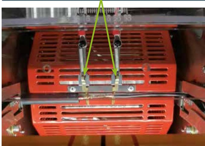
自動化されたガイドアームがチューブを定位置に配置してヒートサイクル開始を準備する
