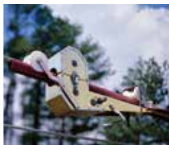
A) Outil d'installation pour conducteurs de caténaire
